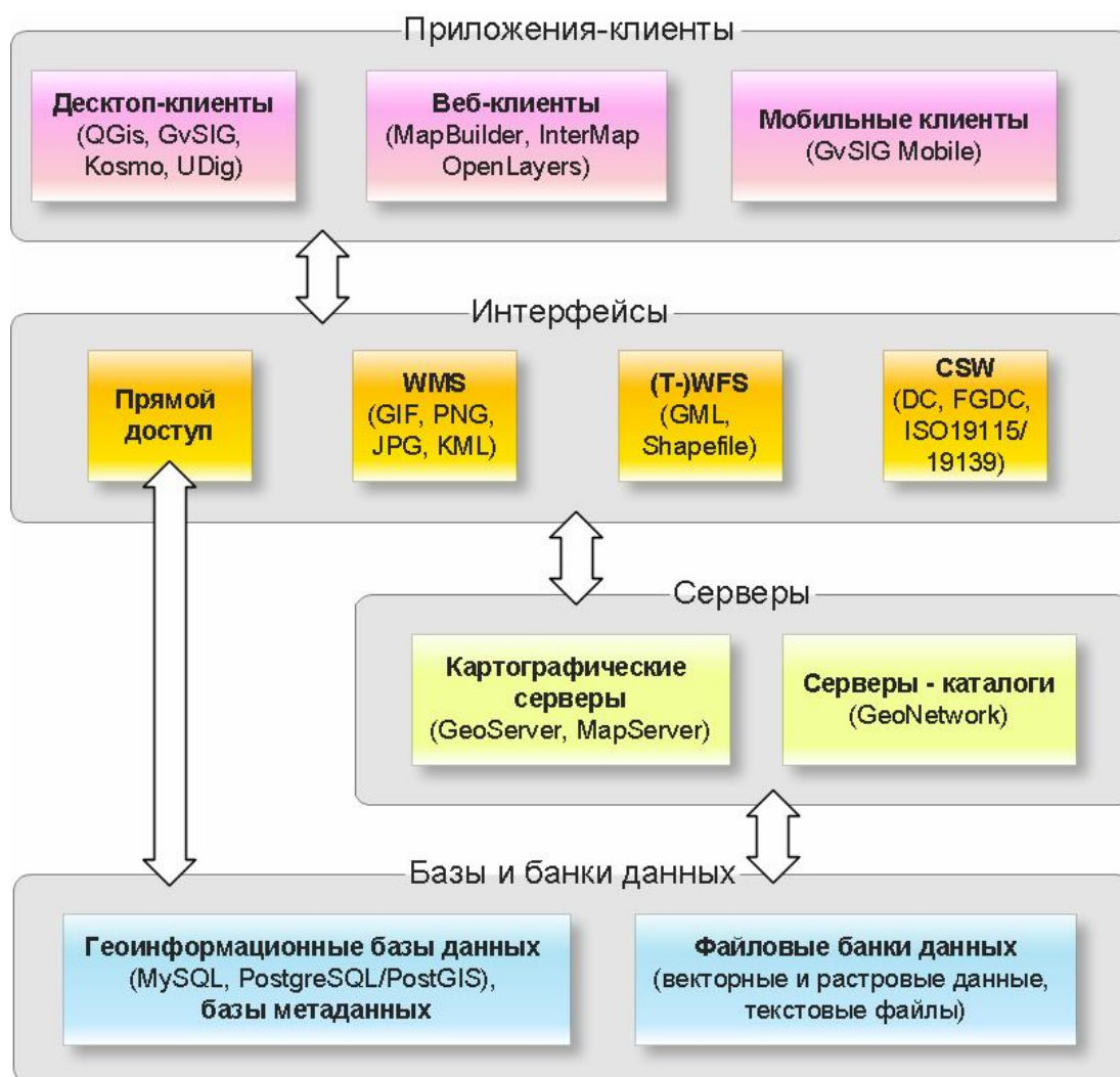
Рисунок 1 – Модель программной инфраструктуры ГИС на основе свободного программного обеспечения (по материалам GeoNetwork Opensource)
