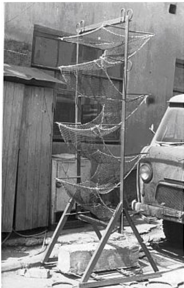
Рисунок 3. Коллектор («этажерка»), с уложенным каскадом (с карманами) сетным прямоугольным полотном
