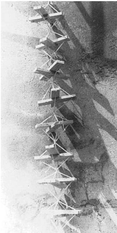
Рисунок 8. Коллектор из крестообразных пенопластовых вставок и 4-х веревочных образующих
