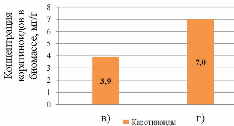
Фиг.4 - влияние вносимых добавок перекиси водорода и пиридоксина на содержание каротиноидов в образцах биомассы Chlorella sorokiniana
